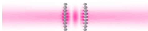
Lys kan spærres inde mellem to gitre af atomer og opnå partikel-lignende egenskaber.
