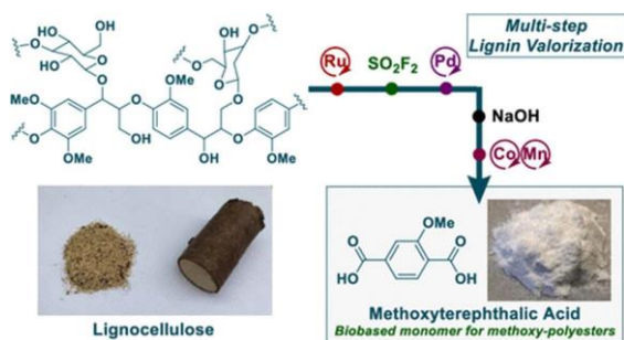
Figur 2: Syntetisk tilgang fra savsmuld til en PET-analog, der involverer et CO 2 -inkorporeringstrin.
