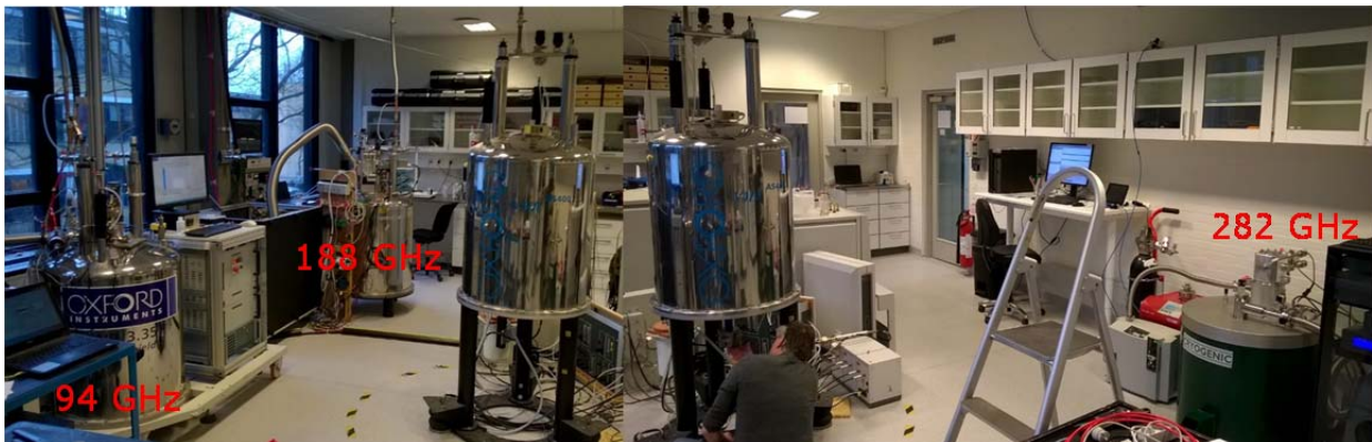
Hyperpolarisations- og NMR laboratoriet med 400 MHz NMR spectrometer i midten og de tre polarisatorer ved 94 GHz, 188 GHz og 282 GHz
